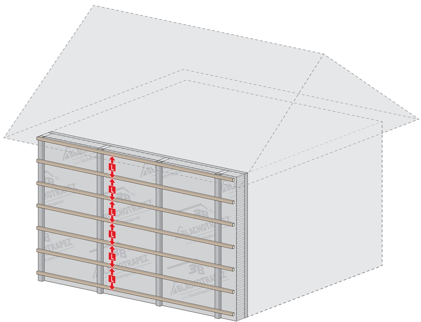
Abstand (L) gemäß Projekt. Hängt von der Art der Konstruktion, der Kerndicke, der Länge der Bleche und der Region ab.
